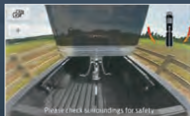
VISTA DE LA CÁMARA CHMSL TRASERA La característica de zoom de esta vista es especialmente útil a la hora de conectar un tráiler 5ª rueda o cuello de ganso.
