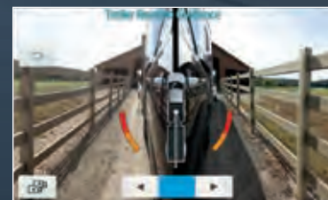
VISTA DE LAS GUÍAS DE MARCHA HACIA ATRÁS PARA REMOLQUE Estas guías conmutan automáticamente entre las vistas de las cámaras laterales y de la cámara de marcha atrás, mostrándote lo más relevante mientras retrocedes con cualquier remolque – incluyendo 5ª rueda y cuello de ganso – y presentándote gráficas en pantalla, a manera de guía.
